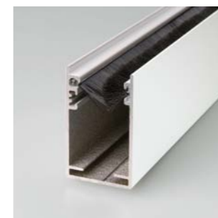
Die Gegenwindbürste verhindert auch bei starkem Wind das Herausrutschen des Gewebes aus der Füh- rungsschiene
