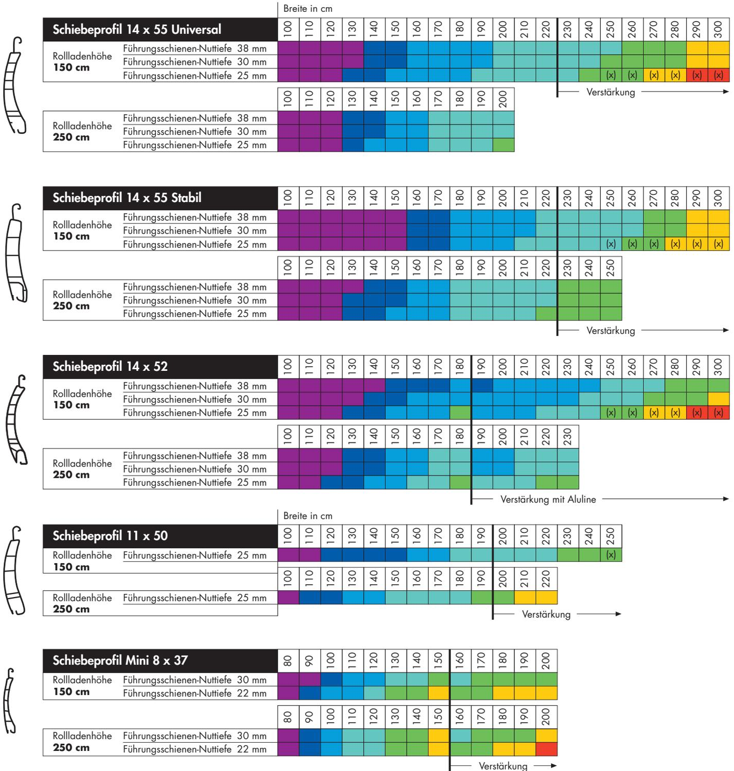
(x) Nach DIN 18073 muss die Tiefe der Laufschiene mind. 1% der Breite des Rollladenpanzers betragen.
