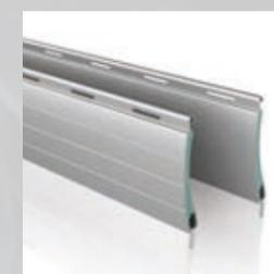
**Profile Alustrong 14 x 52** bestehen aus rollverformten doppelwandigen Aluminium, ausgeschäumt mit PU-Schaum und sind äußerst widerstandsfähig gegen Einbruchversuche.
