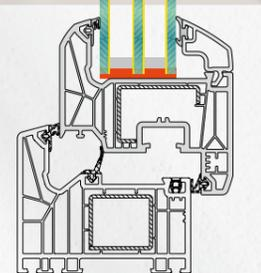
Höhere Stabilität durch Verklebung der Verglasung im Fensterflügel
