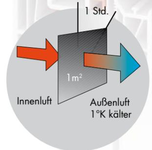
Wärmeschutzglas z.B. U<sub>g</sub> = 1,1 W/m<sup>2</sup>K
