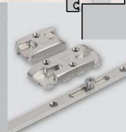
Sicherheitsschließstücke verhindern das Aushebeln des Flügels: Durch mehrere Sicherheitsschließstücke ist das Aufhebeln des Flügels mit üblichen Einbruchwerkzeugen kaum mehr möglich.
