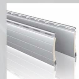
**Profile Aluline 8 x 37** bestehen aus rollverformten doppelwandigen Aluminium, ausgeschäumt mit PU-Schaum und sind äußerst widerstandsfähig gegen Einbruchversuche.
