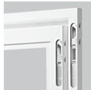
Im Profil eingeschobene Blockmagnete für Dreh- und Pendeltüren ermöglichen leises Schließen, weil die Bürste durchgehend ist
