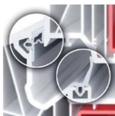
Schraubnocken bzw. mehrere Profilwandun-gen für eine sichere Beschlagbefestigung
