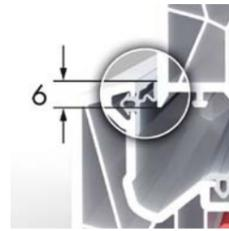
Hohe Funktionssicher-heit durch 6 mm Flügel-überdeckung außen und 8 mm innen
