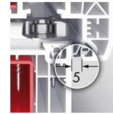
Hohe Toleranzaufnah-men durch 5 mm Dich-tungsspaltmaß zwischen Blendrahmen und Flügel-rahmen sorgen für ein weiches Schließen.
