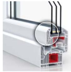
Exklusives Flügelprofil-Design mit 7-Kammer-Geometrie und einer Rahmenbautiefe von 82 mm für hervorragende thermische Isolation
